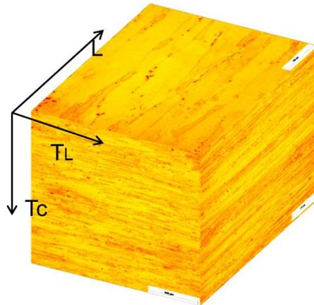
**Figure 1: Microstructure de l'Alu 7050-T7451 (L= sens de laminage ; TL= transversale long ; TC= transversale court).**
