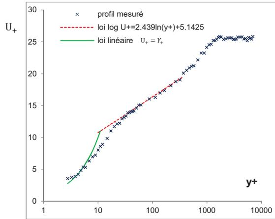
Figure 2.4 Profil de vitesse longitudinale moyenne mesurée en monophasique par LDV ( $x=0.705$  m) et comparaison aux lois théoriques
