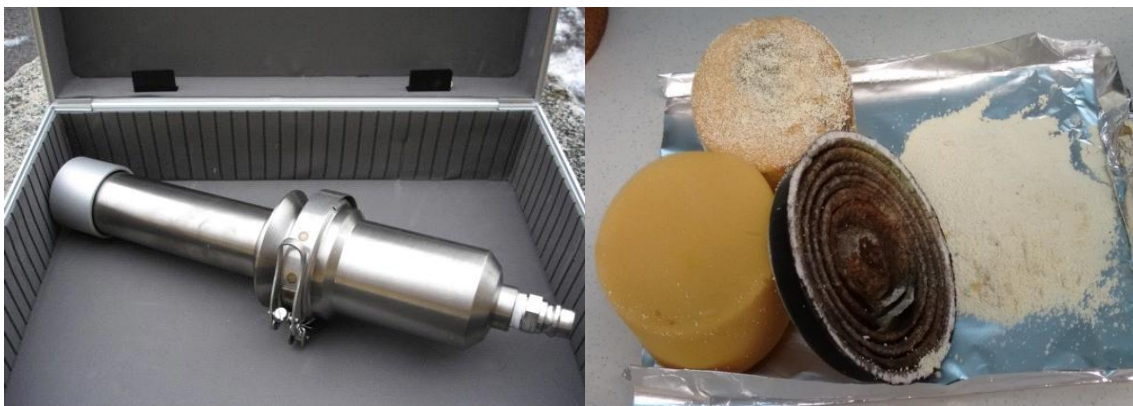
Fig 2.6: Dispositiu porta-filtre i contingut: filtre de partícules (eficiència >99.5%), dos blocs de PUF i amberlita.
