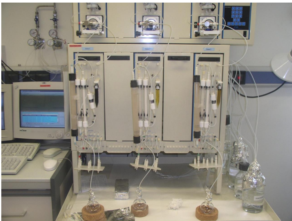
Fig 2.7. Sistema de purificació automàtica Power-Prep de 3 línies, amb jocs de tres columnes: sílice multicapa, alumina i carbó actiu.
