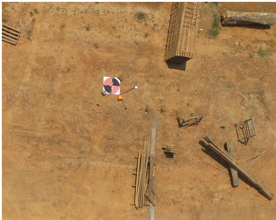
Figura 2. Imagem aérea obtida com RPA/ARP durante a realização dos três planos de voo avaliados (30, 40 e 50 metros de altura) com detalhe de um dos alvos posicionados na área do pátio madeireiro, Distrito Industrial, Rio Branco, Acre, 2015.
