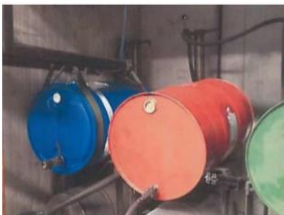
Figura 8: Acondicionamento dos produtos químicos, cumprindo as questões de segurança e saúde/ambiente associadas às instruções de trabalho da Grohe Portugal. Bidão azul: conservante. Bidão vermelho: resina. Bidão verde: endurecedor.
