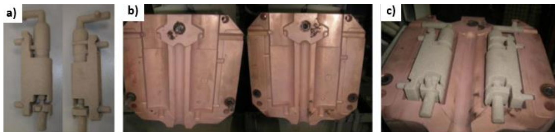
Figura 10: Exemplo de machos produzidos na Grohe Portugal (a), respetiva coquilha para duas peças (b) e a sua colocação na coquilha (c).
