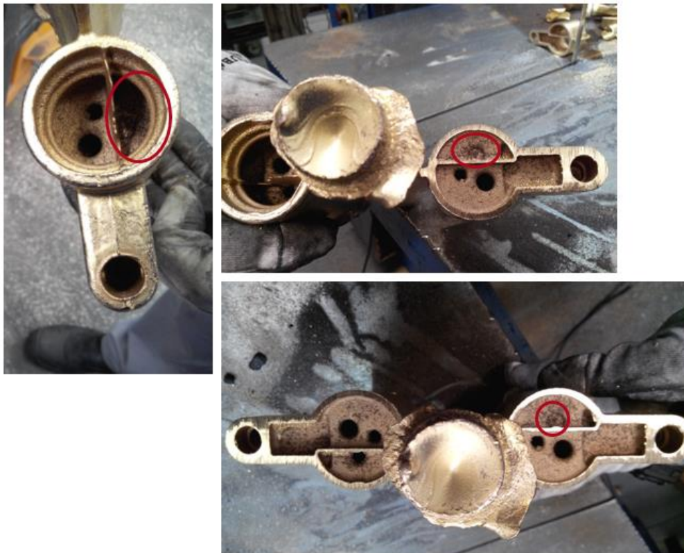
Figura 50: Canal parcialmente entupido, detetado no produto 405 822 029.
