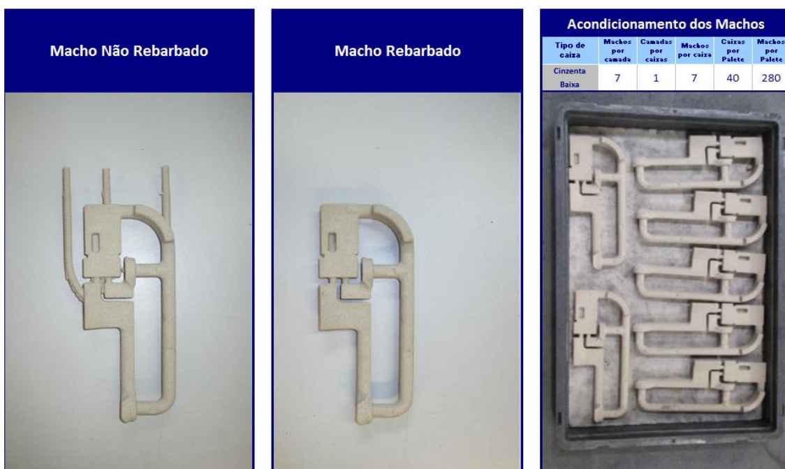
Figura 46: Folha de rebarbagem e acondicionamento dos machos do produto 405 013 051.
