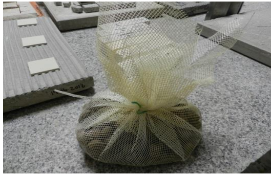
Figura 27-Volume de Leca a imergir para o ensaio de resistência aos sais
