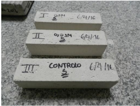
Figura 30-Provetes de APC submetidos ao ensaio de sais de sulfatos
