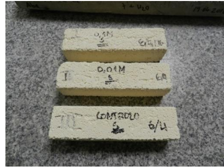
Figura 31-Provetes de APT submetidos ao ensaio de sais de sulfatos
