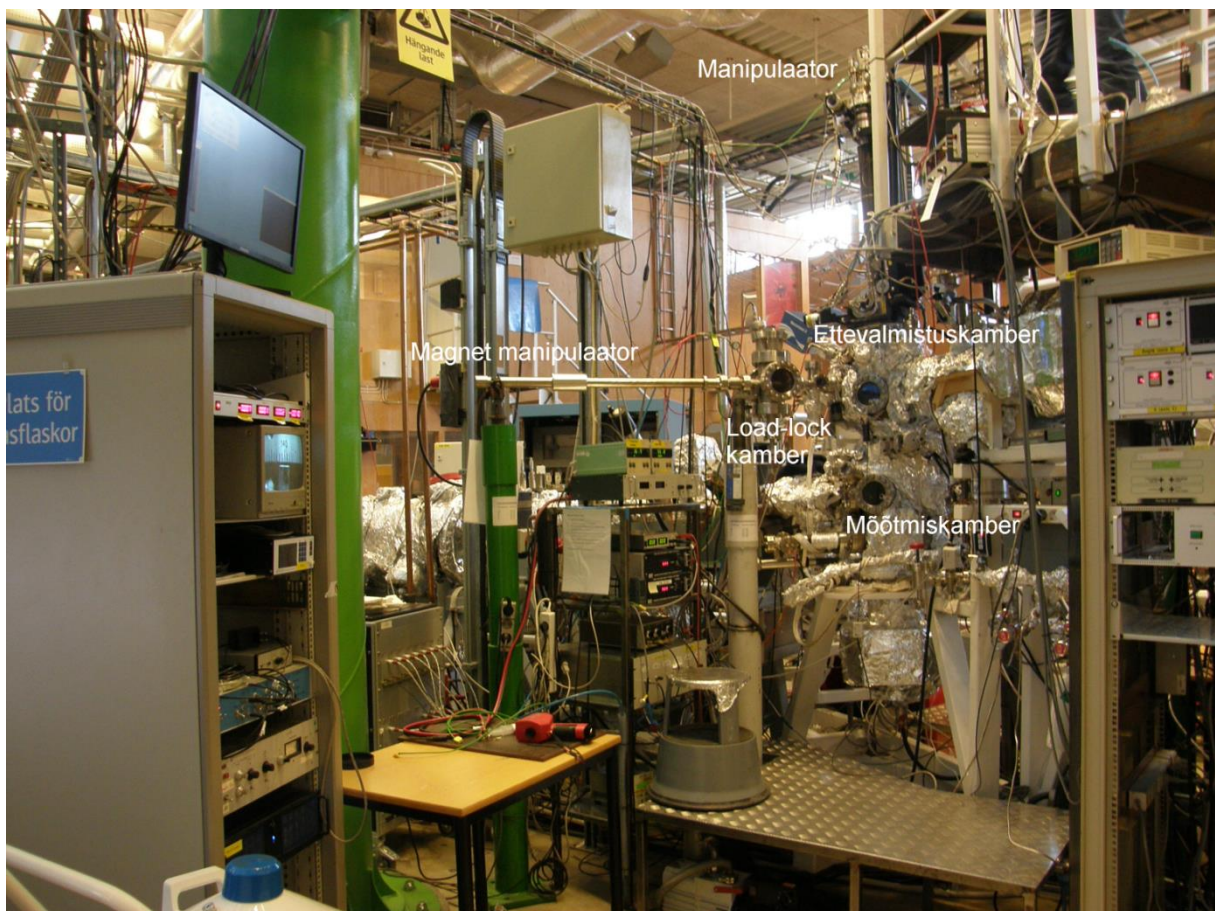
Joonis 9. Kiirekanali D1011 skeem XPS ja NEXAFS eksperimendijaam.
