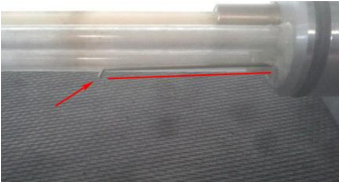
Joonis 25. Punase noolega on näidatud vesiniku sissevoolu düüs. Punane joon märgib vesiniku voolutoru, mis on ühendatud alumiiniumist hoidjaga.
