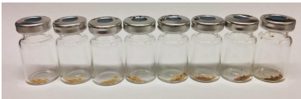
Joonis 10. Erinevatel temperatuuridel analüüsitud proovid peale analüüsi läbiviimist, alustades vasakult: 50°C, 150°C, 200°C, 210°C, 220°C, 230°C, 240°C, 250°C.
