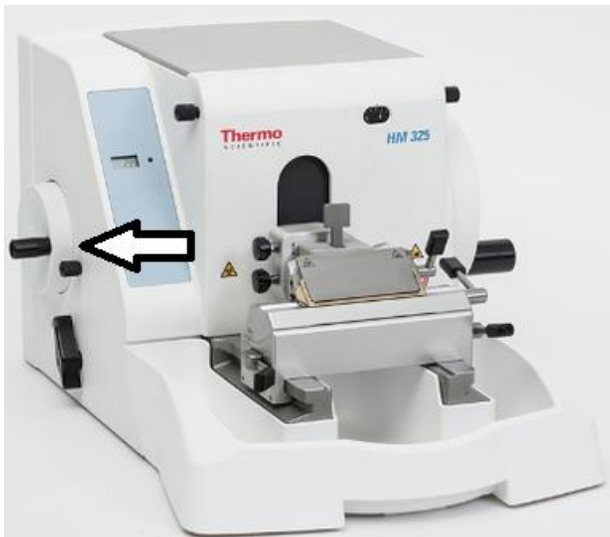
Joonis 3. Rotatsioonmikrotoom HM 325. Noolega on märgitud juhtimiskangi asukoht. [11]
