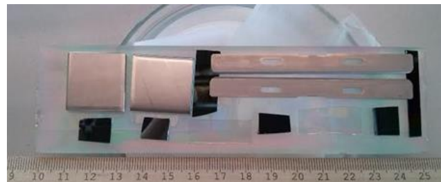
Joonis 19. Spetsiaalne alus suurema koguse terade reaktorisse asetamiseks (vasak); terade paigutus tera nr 7 korral, aluse parempoolne ots oli reaktori väljundava poolseks otsaks.
