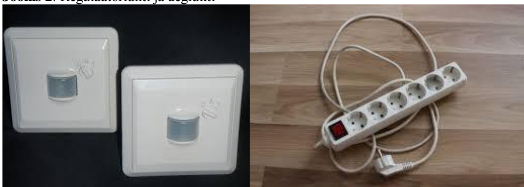
Joonis 3. Hämarlüliti (vasakul), lülitiga pikendusjuhe (paremal)
