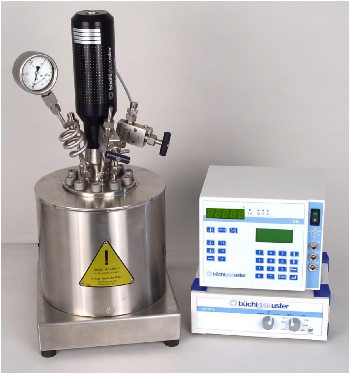
Lisa 7. HTC protsessi läbiviimiseks kasutatud autoklaav koos kontrolleriiga.
