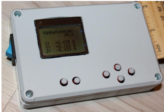
Pilt 3: Valmis ehitatud magnetomeeter.
