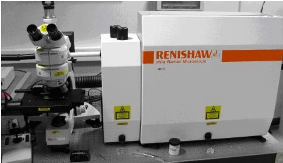
Joonis 20. Tartu Ülikooli Füüsika Instituudis asuv Raman spektromeeter Renishaw inVia Raman Microscope . (Pildi allikas: õppeaine „Spektroskoopia alused“ praktikumijuhend)
