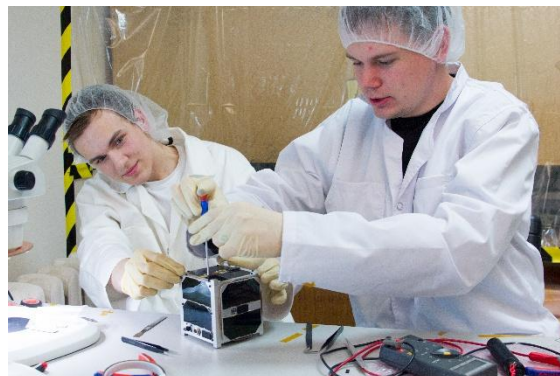
Joonis 1. Ühe ühikuline kuupsatelliit ESTCube-1
