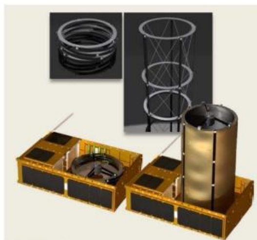
Joonis 25. NASA Ames uurimiskeskuse 6U lahti pakkiv teleskoop [75]
