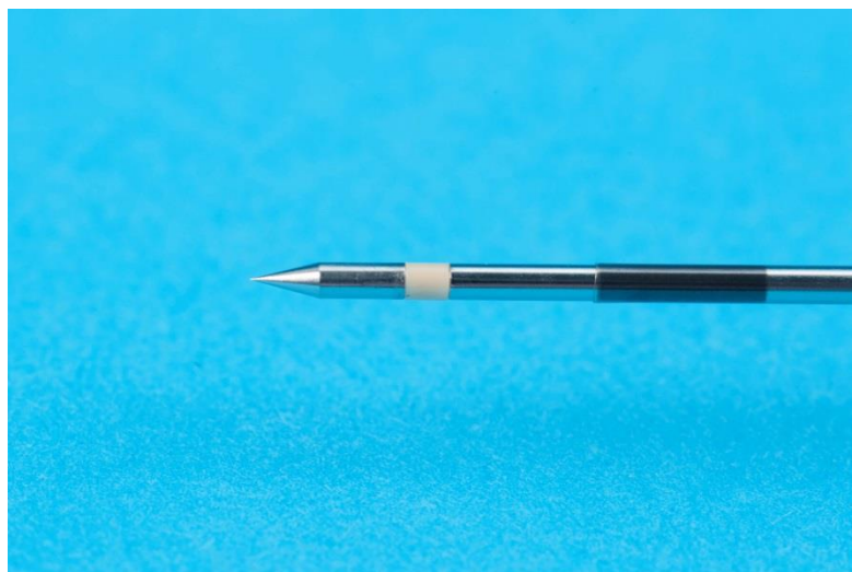
Abbildung 9: Bipolare Nadelelektrode zur interstitiellen Behandlung. Die beiden aktiven Pole an der Spitze werden von einem Isolator (weiß) getrennt. Die breite schwarze Isolationszone dient der Gewebeisolation.
