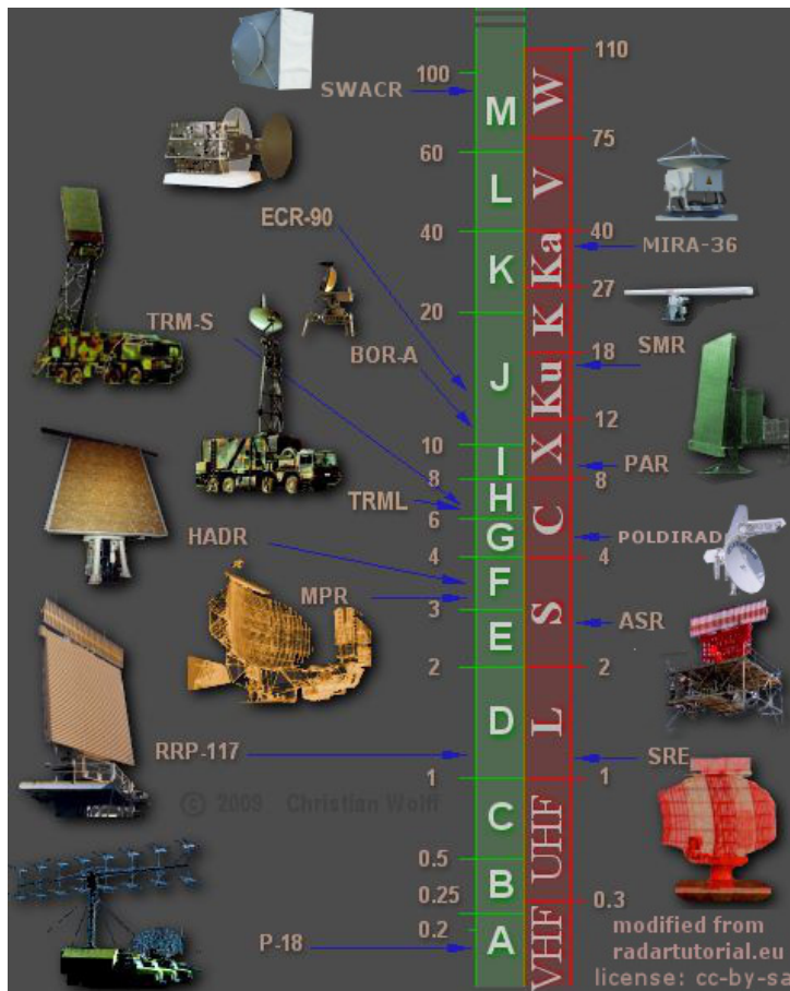
Abbildung 2.16: IEEE- (rote Skala) und NATO-Radar-Bänder mit Frequenzabgrenzungen und Beispielen für verwendete Radargeräte. Meteorologische Radare in dieser Graphik sind das POLDIRAD (Polarization Diversity Doppler Radar) Regenradar des DLR Oberpfaffenhofen (5,45 cm , 5,5 GHz ), das MIRA-36 (Millimeter Radar-36) Wolkenradar der Firma METEK (8,5 mm , 35,3 GHz ) und das SWACR (Scanning W-Band ARM Cloud Radar) Wolkenradar der Atmospheric Radiation Measurement (ARM) Climate Research Facility des US-Energie-Ministeriums (3,2 mm , 93,7 GHz ).
