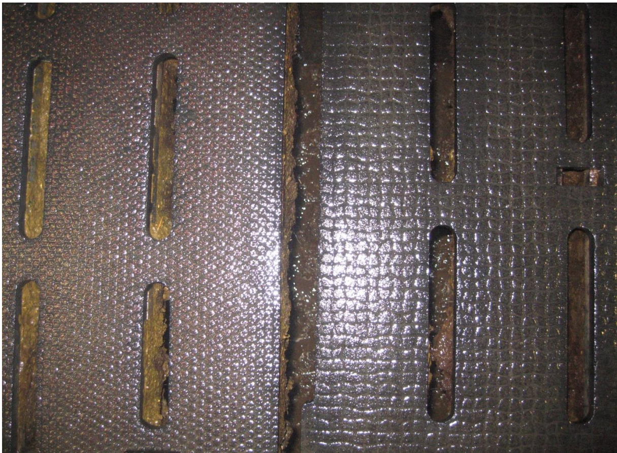
Abbildung 3-5: Lauffläche im Haltungssystem der Versuchsgruppe (rechts KURA S und links PEDIKURA S, Gummiwerk Kraiburg, GmbH)
