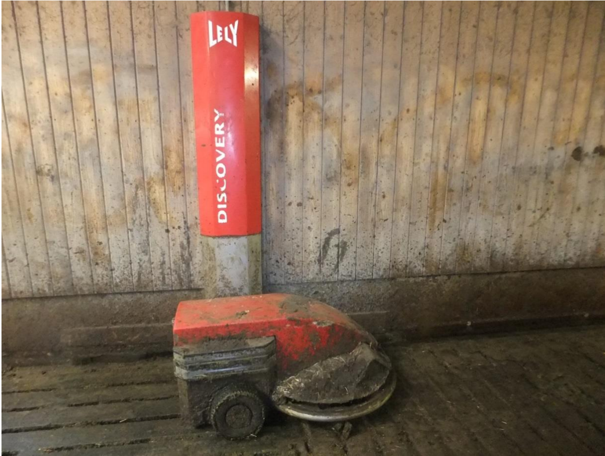
Abbildung 3-2: Entmistungssystem am Lehr- und Versuchsgut Oberschleißheim
