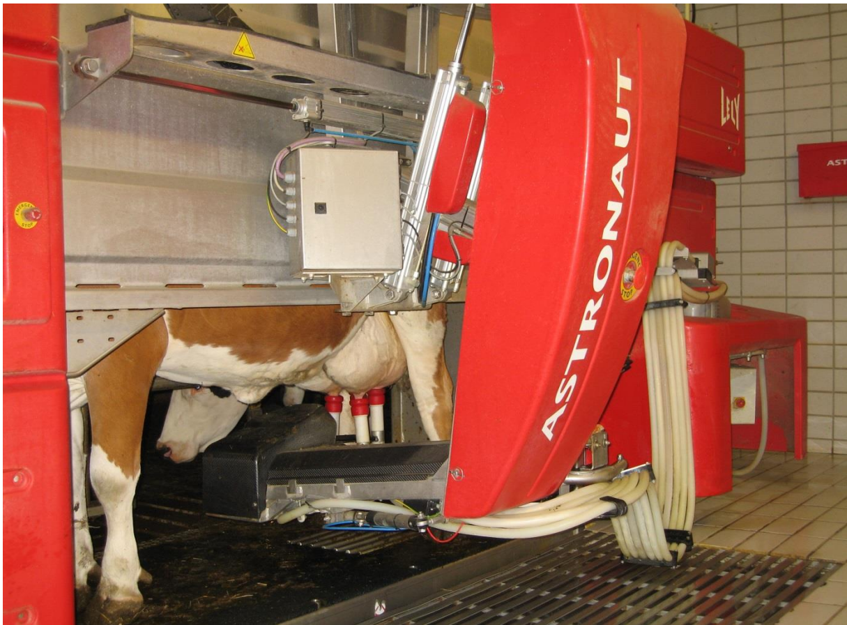
Abbildung 3-10: Automatisches Melksystem am Lehr- und Versuchsgut Oberschleißheim
