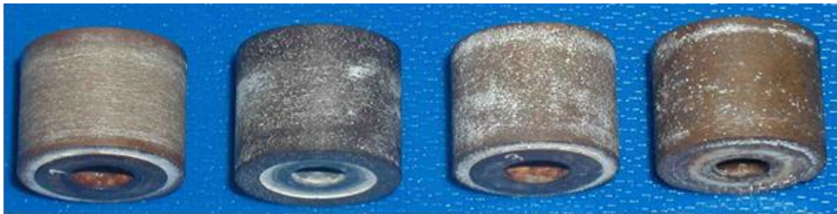
Abb. 6 Vier diamantierte Schleifkörper für das Grinding
