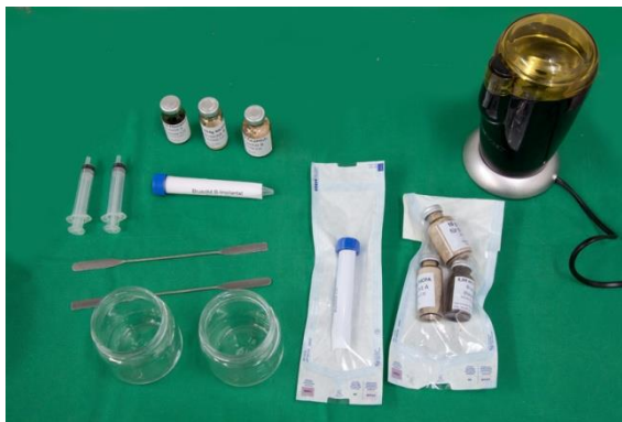
Abb. 7: Utensilien für die Zementherstellung (Brushit)
