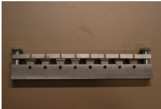
Abbildung 22: Höhenregulation der Probenkörper durch individuell verstellbaren Höhenregulator (Syndicad Ingenieurbüro, München, Deutschland).
