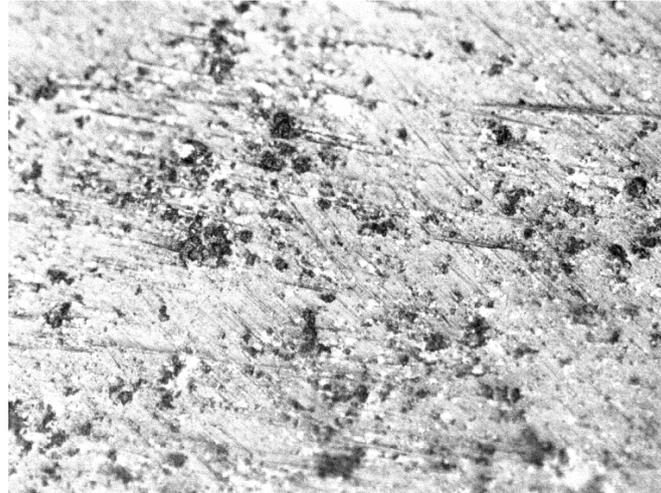
Abbildung 8: Lichtmikroskop-Bild zeigt eine reduzierte Anzahl an Kratzspuren auf der keramischen Oberfläche. Es dominieren kraterförmige Defekte, die auf Materialabtrag durch rollende Partikel hinweisen.
