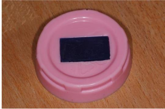
Abbildung 4: Negativform aus additionsvernetzendem Silikon für die Probenherstellung.
