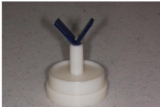
Abbildung 5: Angestiftete Modellation der Probenkörper.
