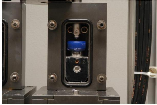
Abbildung 24: Abformung einer Probe mithilfe einer individuellen Abformhilfe (Flaschendeckel).
