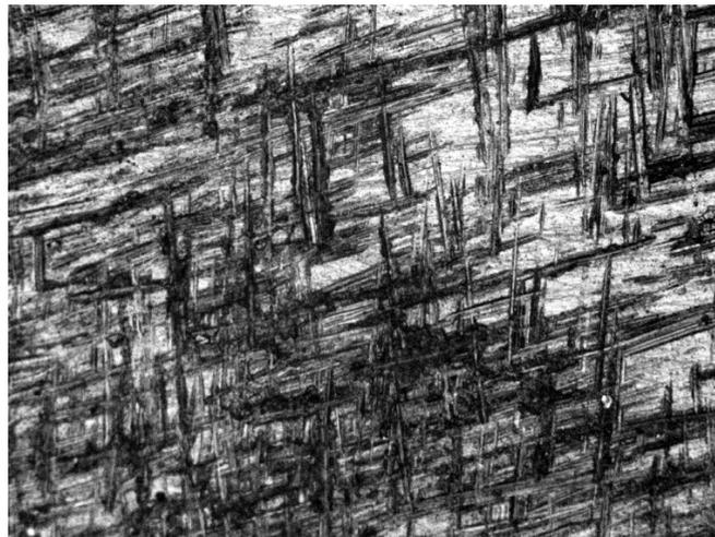
Abbildung 7: Lichtmikroskop-Bild zeigt deutliche Schnittspuren des Abrasivs auf der keramischen Oberfläche nach Politur mit hohem Anpressdruck.
