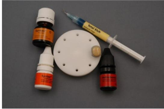
Abbildung 18: Bonding-System zur adhäsiven Befestigung der Keramikprüfkörper.
