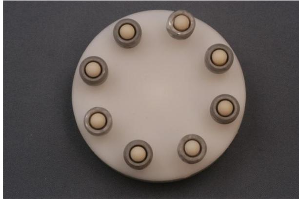
Abbildung 23: Fixierte Aluminiumoxidkeramikugeln (Degussit) in Antagonistenhalterung.
