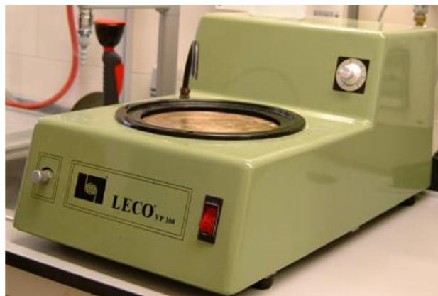
Abbildung 12: Nassschleif- und Poliersystem LECO VP 100.
