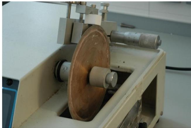
Abbildung 6: LECO VP 100 – Schleifsystem mit Weißkörper (Everest ZS Blank).
