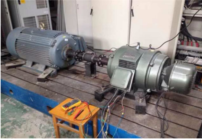
Fig. 10. DFIG machine test rig.
