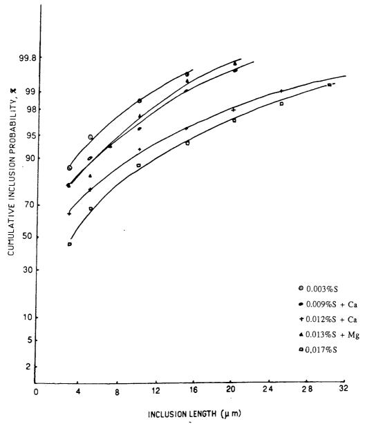
FIGURE 50. CUMULATIVE INCLUSION LENGTH DISTRIBUTION FOR STEELS 1-5
