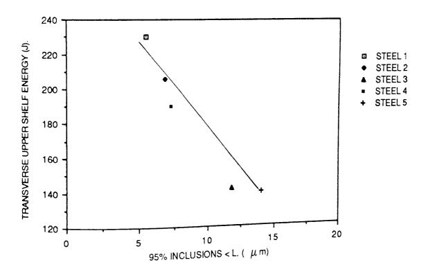
FIGURE 103. TRANSVERSE UPPER SHELF ENERGY VERSUS INCLUSION LENGTH DISTRIBUTION FOR STEELS 1-5
