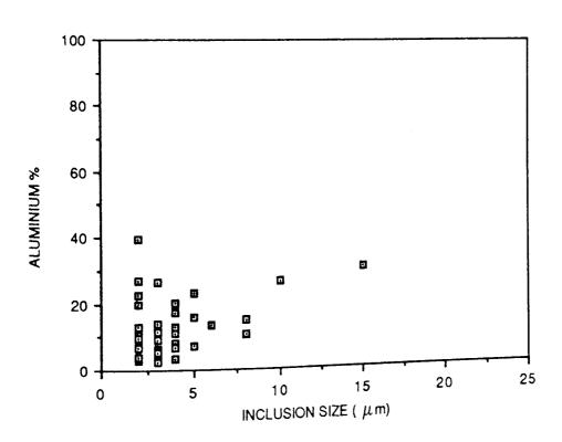
FIGURE 77. INCLUSION SIZE VERSUS ALUMINIUM CONTENT FOR STEEL 4.
