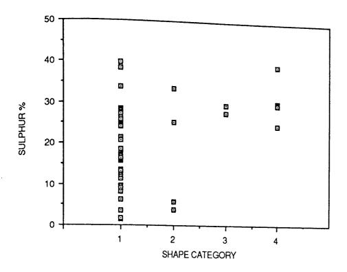
FIGURE 59. INCLUSION SHAPE VERSUS SULPHUR CONTENT FOR STEEL 2.
