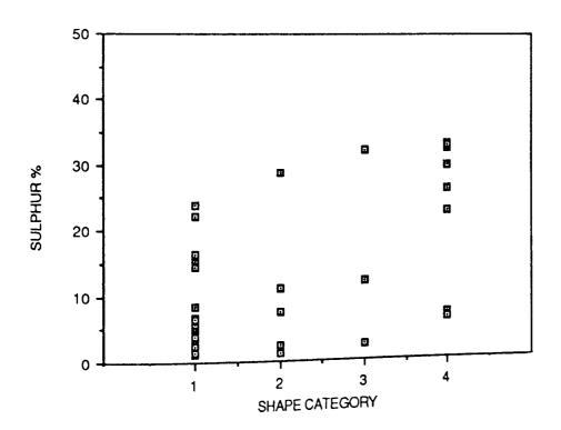
FIGURE 60. INCLUSION SHAPE VERSUS SULPHUR CONTENT FOR STEEL 3.
