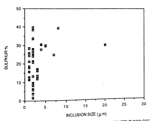
FIGURE 54. INCLUSION SIZE VERSUS SULPHUR CONTENT FOR STEEL 2.
