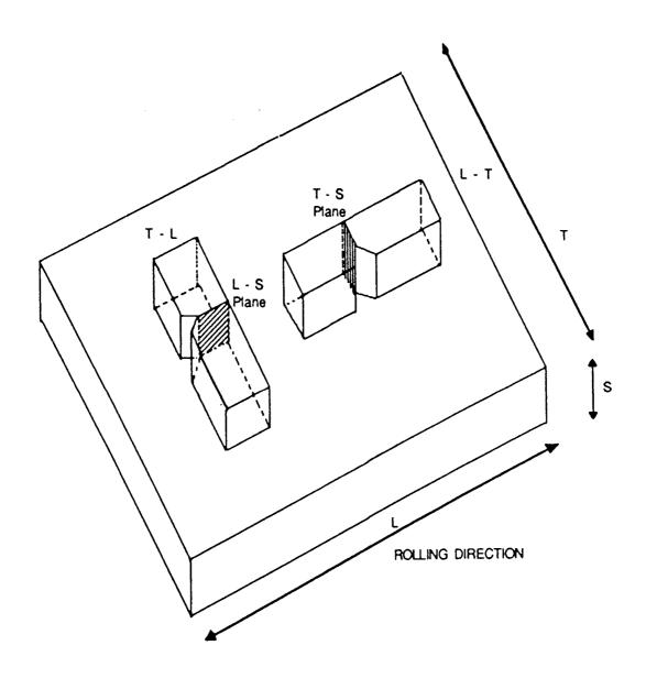
FIGURE 18. SPECIMEN ORIENTATION AND PLANES OF EXAMINATION
