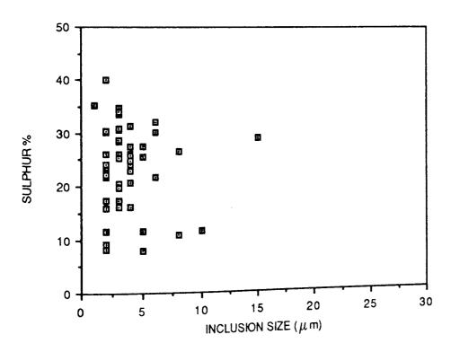
FIGURE 56. INCLUSION SIZE VERSUS SULPHUR CONTENT FOR STEEL 4.
