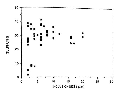
FIGURE 57. INCLUSION SIZE VERSUS SULPHUR CONTENT FOR STEEL 5.
