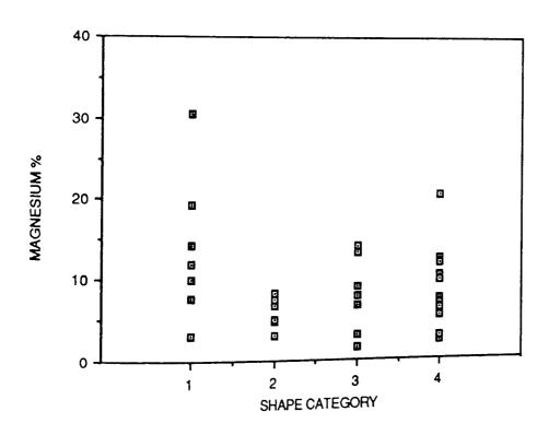
FIGURE 73. INCLUSION SHAPE VERSUS MAGNESIUM CONTENT FOR STEEL 4.
