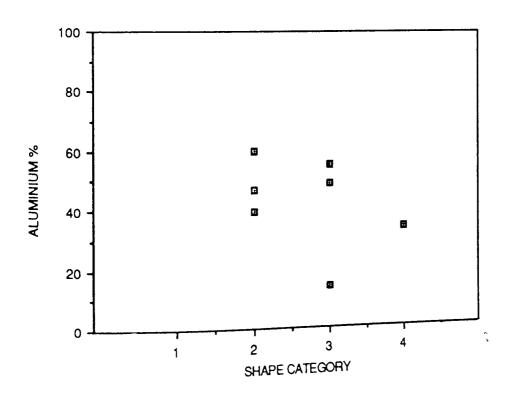
FIGURE 83. INCLUSION SHAPE VERSUS ALUMINIUM CONTENT FOR STEEL 5.
