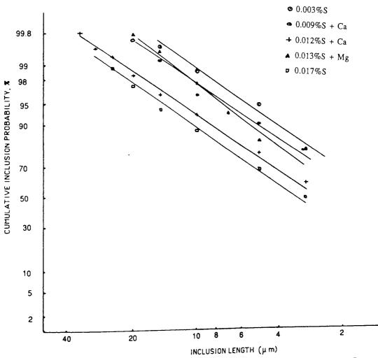
FIGURE 51. CUMULATIVE INCLUSION LENGTH DISTRIBUTION FOR STEELS 1-5
