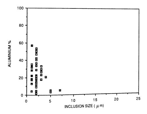
FIGURE 75. INCLUSION SIZE VERSUS ALUMINIUM CONTENT FOR STEEL 2.
