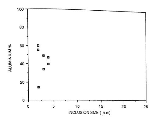
FIGURE 78. INCLUSION SIZE VERSUS ALUMINIUM CONTENT FOR STEEL 5.
