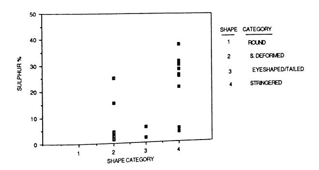
FIGURE 58. INCLUSION SHAPE VERSUS SULPHUR CONTENT FOR STEEL 1.
