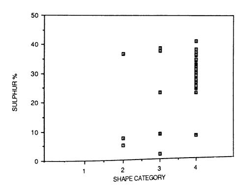
FIGURE 62. INCLUSION SHAPE VERSUS SULPHUR CONTENT FOR STEEL 5.
