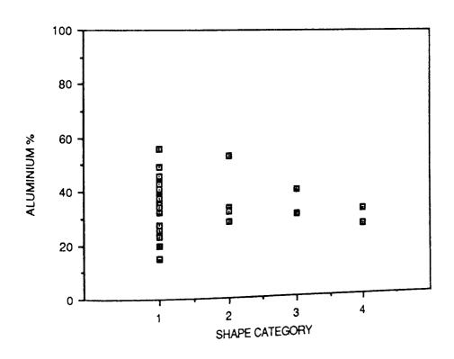
FIGURE 81. INCLUSION SHAPE VERSUS ALUMINIUM CONTENT FOR STEEL 3.
