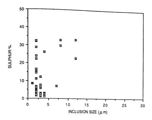
FIGURE 55. INCLUSION SIZE VERSUS SULPHUR CONTENT FOR STEEL 3.
