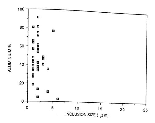
FIGURE 74. INCLUSION SIZE VERSUS ALUMINIUM CONTENT FOR STEEL 1.
