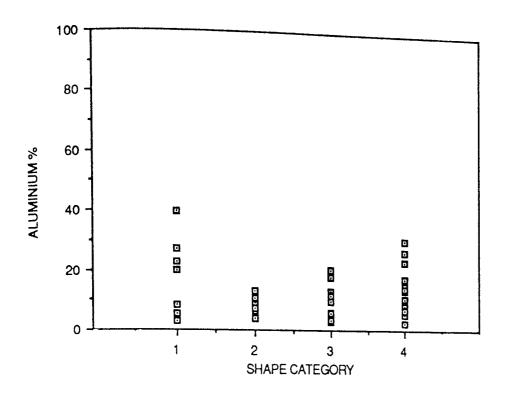
FIGURE 82. INCLUSION SHAPE VERSUS ALUMINIUM CONTENT FOR STEEL 4.
