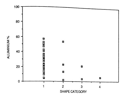
FIGURE 80. INCLUSION SHAPE VERSUS ALUMINIUM CONTENT FOR STEEL 2.
