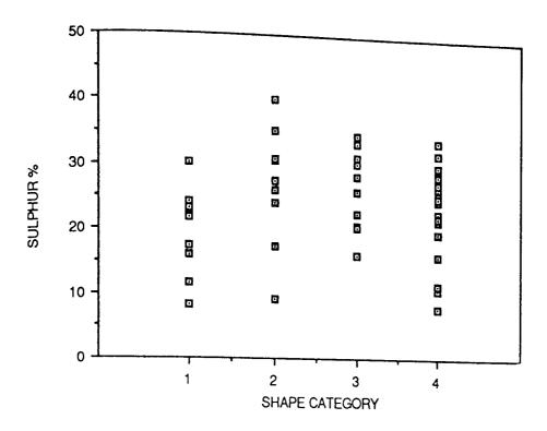
FIGURE 61. INCLUSION SHAPE VERSUS SULPHUR CONTENT FOR STEEL 4.
