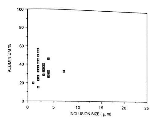
FIGURE 76. INCLUSION SIZE VERSUS ALUMINIUM CONTENT FOR STEEL 3.
