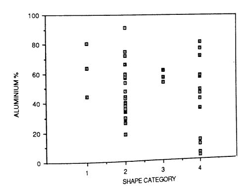
FIGURE 79. INCLUSION SHAPE VERSUS ALUMINIUM CONTENT FOR STEEL 1.
