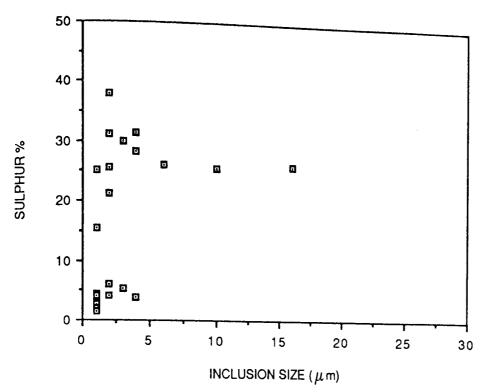
FIGURE 53. INCLUSION SIZE VERSUS SULPHUR CONTENT FOR STEEL 1.
