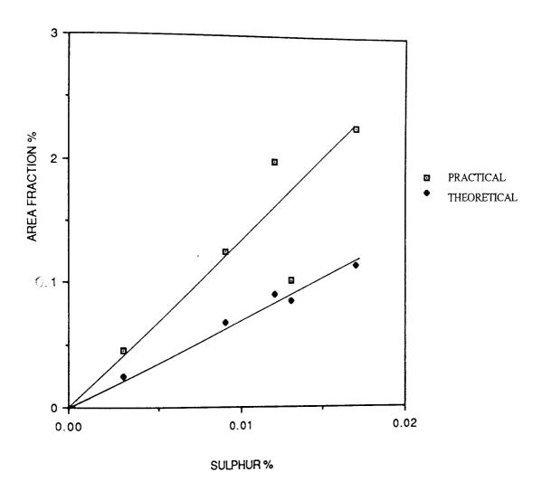
FIGURE 52. INCLUSION AREA FRACTION VERSUS STEEL SULPHUR CONTENT
