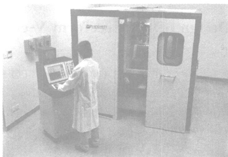
图10 (Freeform 705G) 5轴自由曲面超精密加工设备
