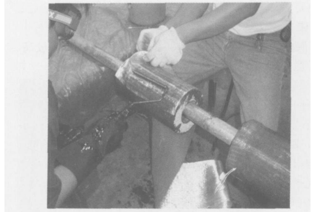
图 3 湿粘法制作 FRP 管
