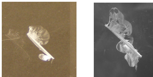
图 9 低温有机玻璃中表面圆片裂纹的翼形开裂 [5-7]
