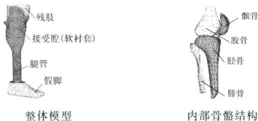
图1 三维非线性残肢界面应力分析有限元模型
