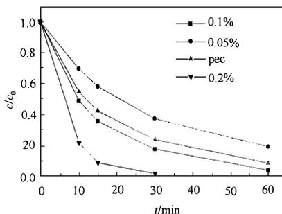
图 10 在不同浓度 TiO<sub>2</sub> 悬浆和光电催化氧化中若丹明 B 随时间的降解
