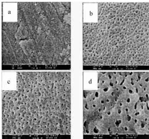
图 3 不同电压下制备的  $\text{TiO}_2$  膜电极表面 SEM 照片
