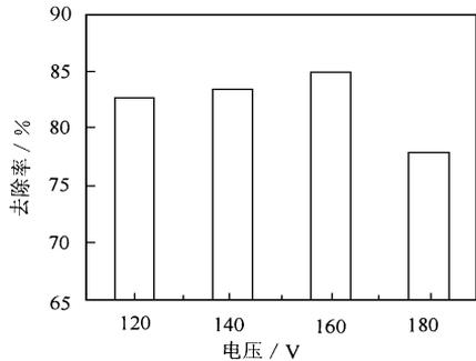
图 5 不同电压下制备  $\text{TiO}_2$  膜电极光电催化氧化若丹明 B 的效果
