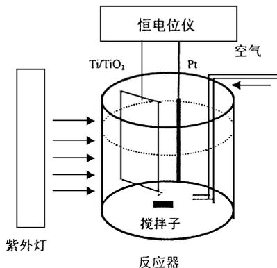
图 2 光电催化氧化实验装置
