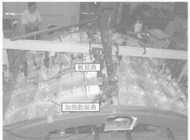
图7 试件A的破坏模式
