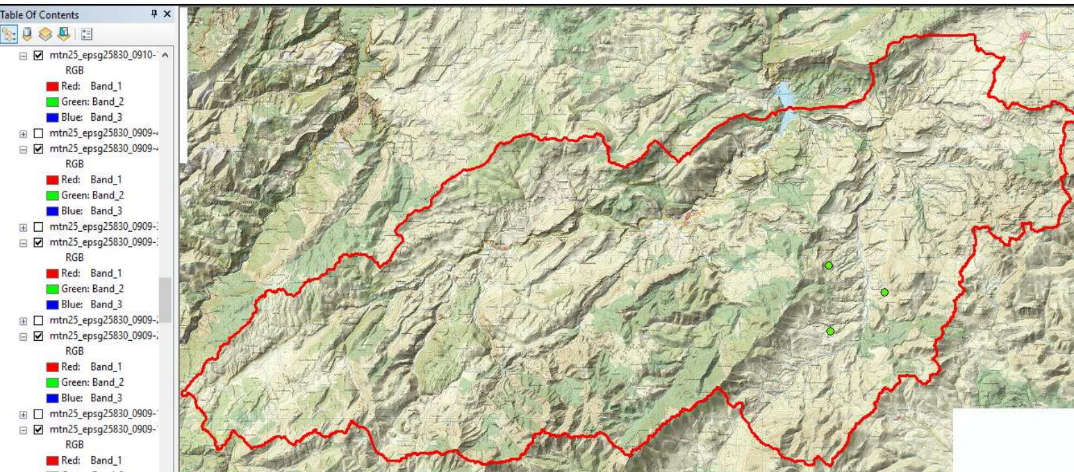
Figura 7. Hojas del Mapa Topográfico Nacional 1:25.000 descargadas para la cuenca alta del río Taibilla. Escala de representación 1:125.000. Fuente: elaboración propia a partir de capas IGN.
