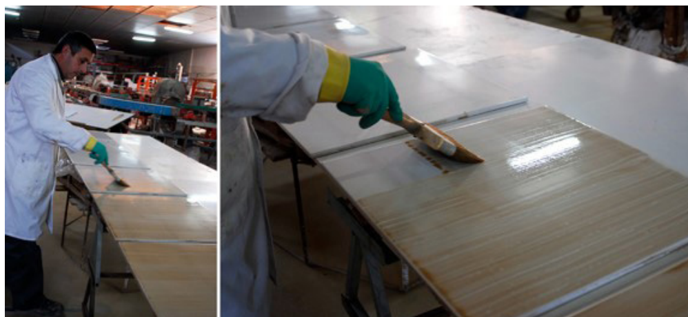
Figura 2. Fotografía del proceso manual de imprimación del cerámico.
