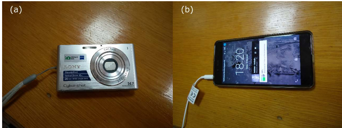
Figura 4. Medios empleados para la adquisición de las fotografías digitales. (a) Cámara digital SONY DSC-W330; (b) teléfono móvil One Plus X.
