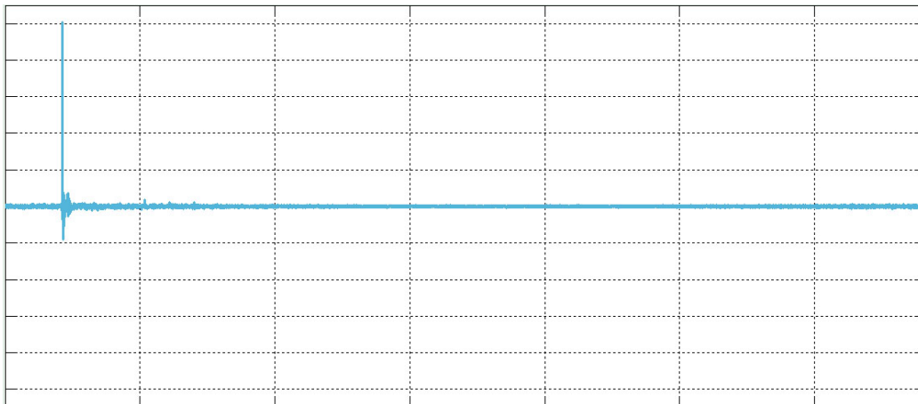
Figura 3.1. Respuesta al impulso de un altavoz de rango completo.
