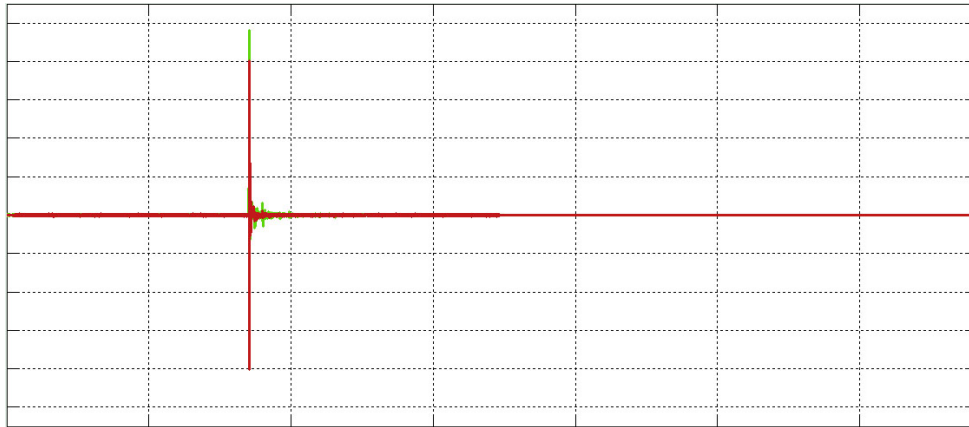
Figura 3.6. Respuesta al impulso del sistema principal (verde) y de relleno frontal (rojo) alineados.
