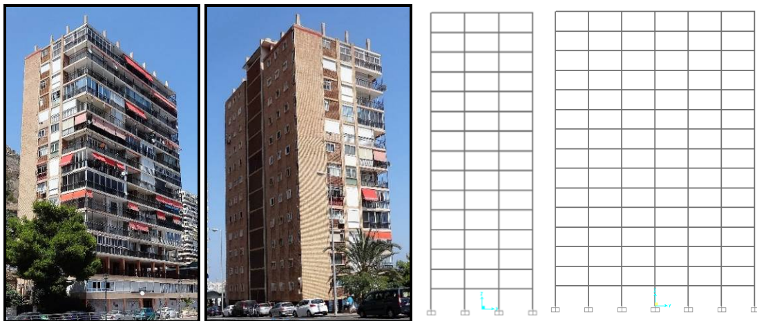
Figura 6. Estructura propuesta nº2. Izq.: Ejemplo real de estructura de hormigón. Drcha.: Modelización numérica mediante elementos finitos
