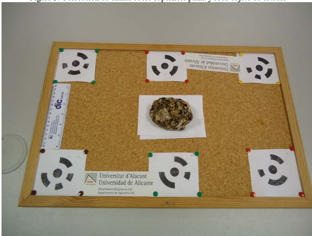
Figura 5. Colocación de dianas sobre superficie plana y roca objeto de estudio
