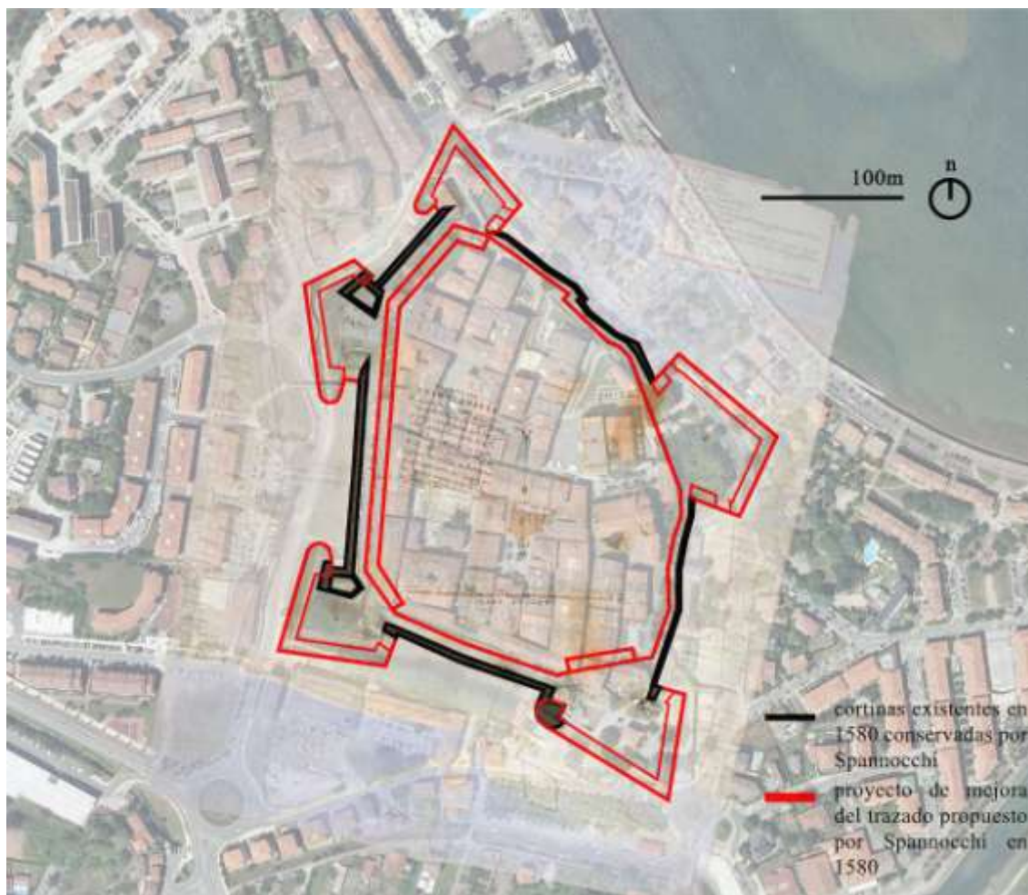
Fig. 19. Inserción del proyecto de Spannocchi (Fig. 8) sobre la trama urbana actual. Elaboración propia.
