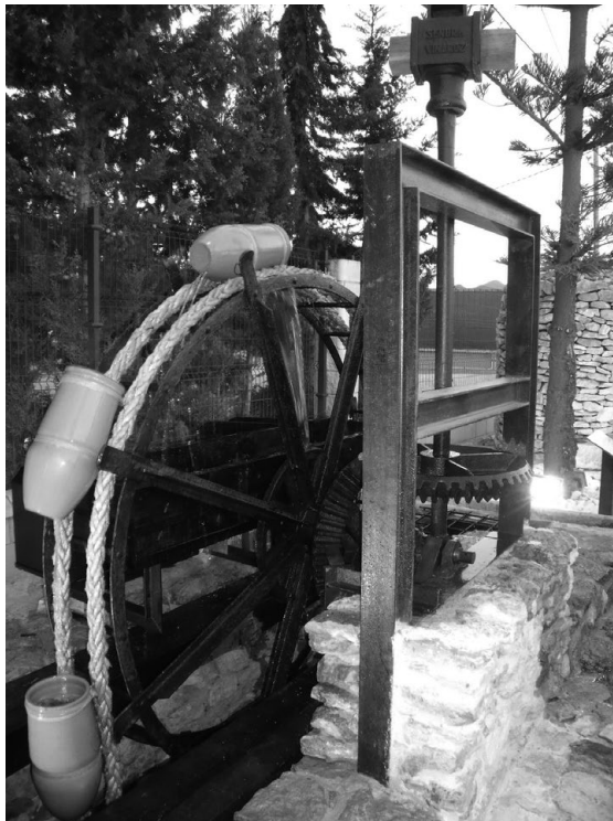
Figura 18. Reproducción de una noria de tiro o de sangre en el Museo del Agua, en el El Saltador (Huércal-Overa). Fuente: Gómez, J.M. a y Gil, E. 28/06/2014.
