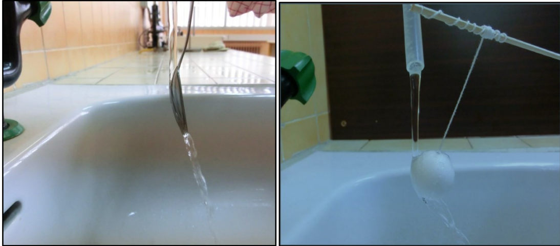
Figura 2.4. Efecte de succió observat en acostar al raig d'aigua (a) la cullera, (b) una boleta lligada amb una corda a una vareta
