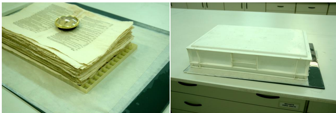
Fig. 201 i 202. Humectació al TR-CRAI. Preparació dels documents sobre una reixeta que els separa de les friselines humides. Es col·loca un higròmetre que ajudarà a controlar la humitat; es tapa tot amb una cubeta per crear el microclima. Font: Autora.
