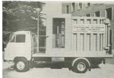
Fig. 3, 4 i 5. Autoclau portàtil per a la desinsectació de 1970; autoclau instal·lat a la Biblioteca Universitària per a la desinsectació de 1934; cambra mòbil per a la desinsectació de 1972. Font: Memòria 1971-1972, 1972:13.
