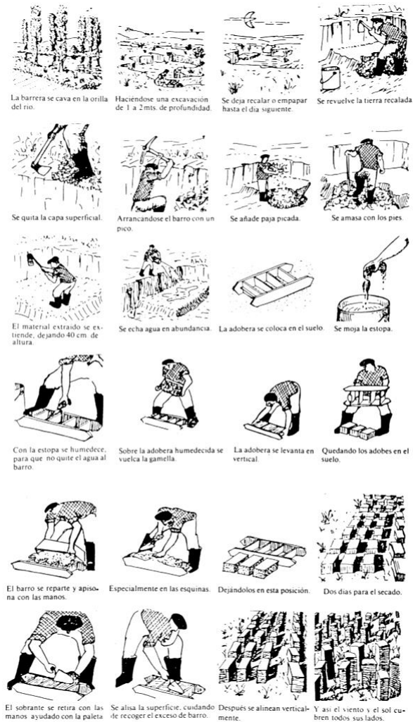
Fig. 1 Procés d'elaboració amb terra crua, des de l'extracció de la matèria primera fins a l'adició d'estabilitzants (desgreixants vegetals) i aigua, així com la posterior posada en obra, en aquest cas concret amb la tècnica dels tovots (Alonso Ponga 1994:27 segons Rohmer).
