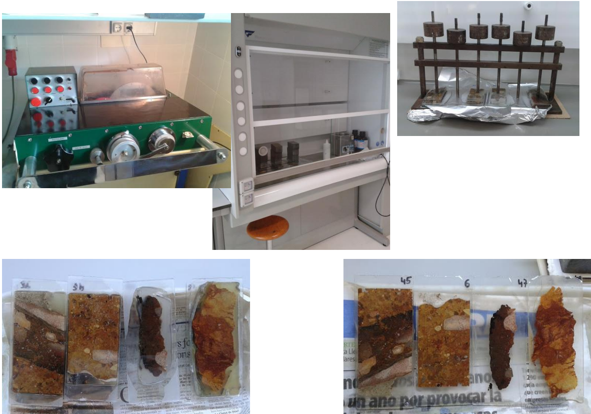
Fig. 26 Laboratori d'elaboració de les làmines primes. Superior: màquina polidora, campana per a l'ús de la resina en l'adhesió de les tauletes de les mostres als portes de vidre, i pesos per poder realitzar aquesta adhesió. Inferior tauletes adherides al porta de vidre, esquerra ja en procés de polit, després de passar per un primer procés de polit. Servei de Micromorfologia i Anàlisi d'Imatges dels Serveis Científicotècnics de la Universitat de Lleida.
