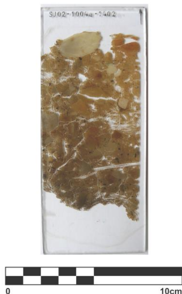
Fig. 27 Fotografia d'una làmina prima d'una mostra de coberta/paviment aeri.
