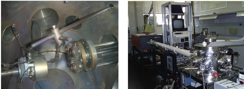
Figura 2.2: Sistema PLD i laboratori on s'han crescut les capes primes de BZT.
