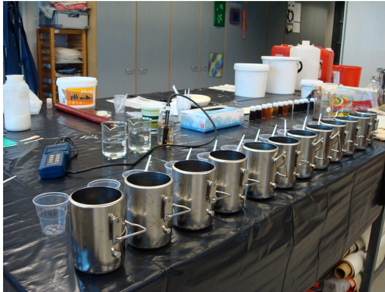
Kuva 10 Värjäyssylinterit ennen liemen kaatamista sylintereihin.
