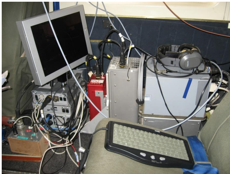
Figure 9. Optech ALTM 3100 ALS Sensor, AISA Eagle hyperspectral sensor and IMU system (photo by Tuure Takala)
