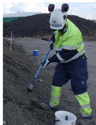
Kuva 1. Esimerkkejä hyvistä näytteenottimista; lapio, pistokaira ja Edelman-kaira (valokuvat K. Björklöf).
