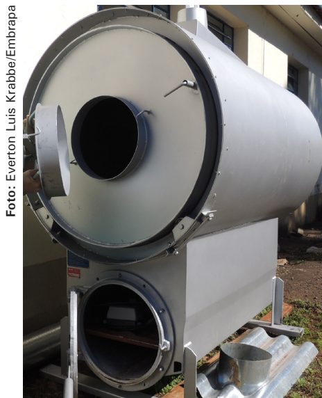
Figura 5. Desidratador de carcaças (doação da Metalúrgica Debona).
