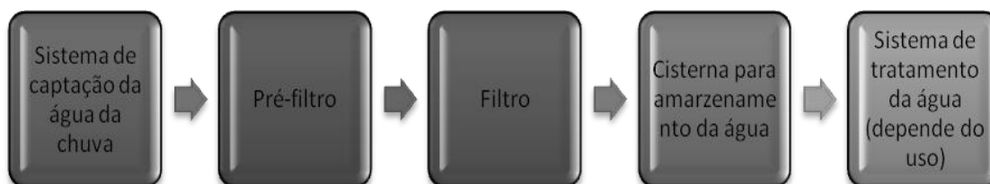
Figura 1. Componentes do sistema de filtração da água da chuva para dessedentação animal.
