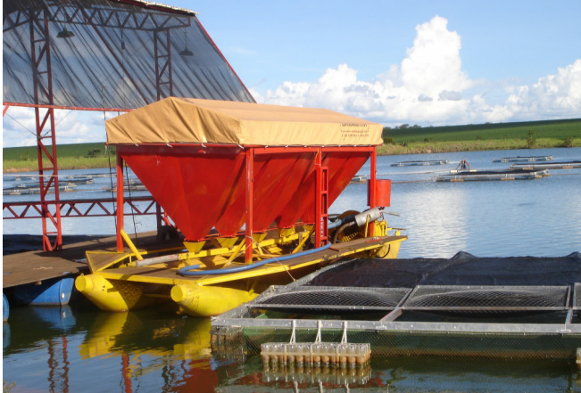
Foto 2. Detalhe de um tanque-rede e da balsa para armazenamento e distribuição de ração para os peixes. Foto: Emiko Kawakami de Resende.
