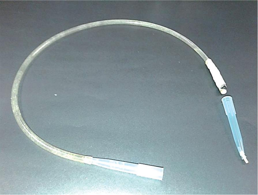
**Figura 1.** Sugador manual acoplado a uma ponteira P1000 adaptada para coletar adultos de mosca-branca.
