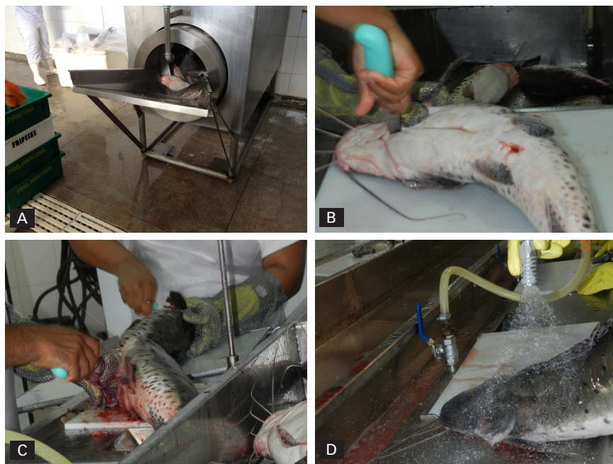
Figura 2. Principais etapas do processamento para produção de “peixe fresco eviscerado”: A) primeira lavagem no cilindro; B) incisão abdominal; C) evisceração; D) lavagem final no peixe na mesa de evisceração. Foto: Viviane Rodrigues Verdolin dos Santos, 2016.
