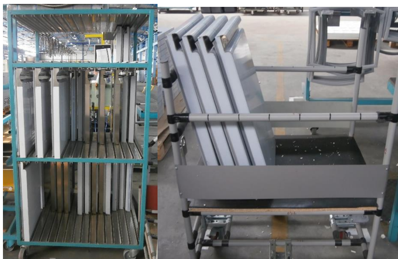
Figura 18: Estante de colocação de portas e gavetas no BL e carro de transporte.
